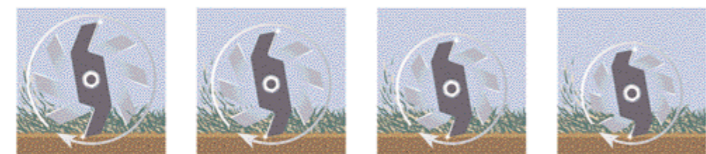
Ny kniv... Efter 30 timmar ... Efter 60 timmar... Efter 90 timmar...
