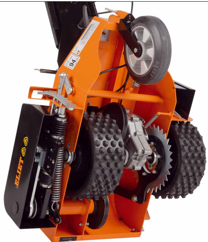
Das Stollenprofil hinterlässt auf dem Rasen keine Spuren. Die lose mitdrehende Anti-Deviationseinrichtung (silberne Zahnscheibe) verhindert seitliches Versetzen der Maschine bei der Arbeit. Die Kraftübertragung vom Motor auf den Radantrieb und auf das Schneidwerk erfolgt mit je einem Keilriemen
