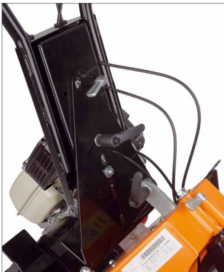
Der Lenkerholm lässt sich sowohl in der Höhe als auch nach rechts und links schwenken. Das ermöglicht den Maschinenbetrieb auch unter beengten Platzverhältnissen
